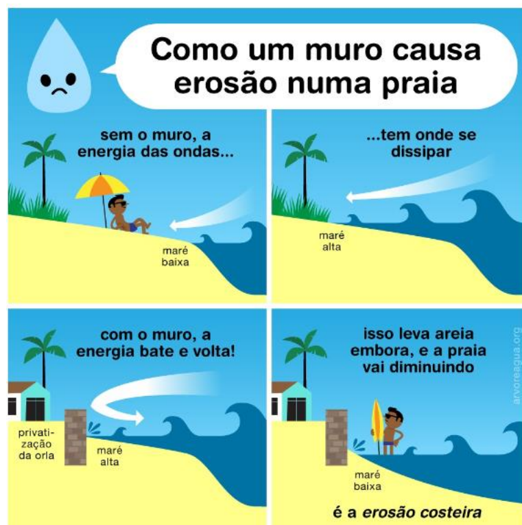
Figura 3 – Estágios evolutivos do comportamento da praia à frente de um enrocamento. Fonte: ARVOREAGUA, 2024.
